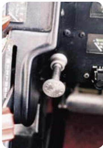
Manual primer system, on a Piper Tomahawk.
